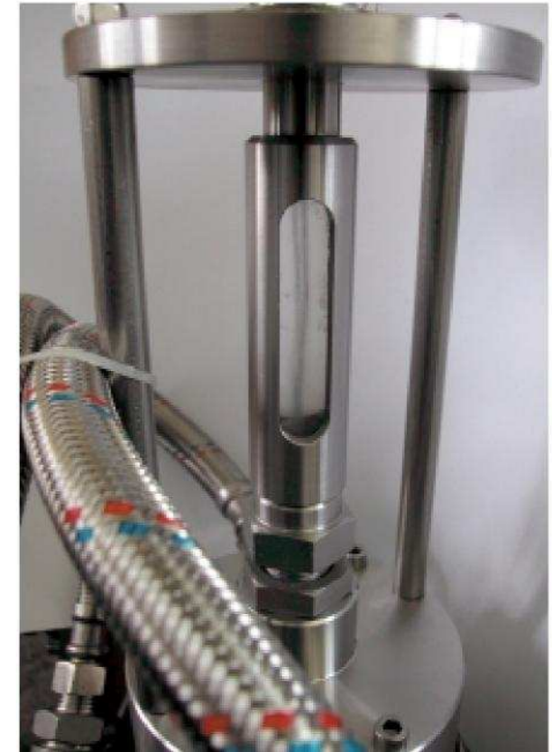
Abb.: optische Ausbildung des Kavitationsfadens
